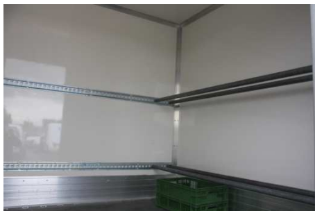
System zabezpieczania ładunku za pomocą poziomego drążka na dwóch wysokościach.
