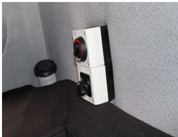
Rura wyjścia ciepłego powietrza ze sterownikiem temperatury umieszczone w kabine sypialnej.
