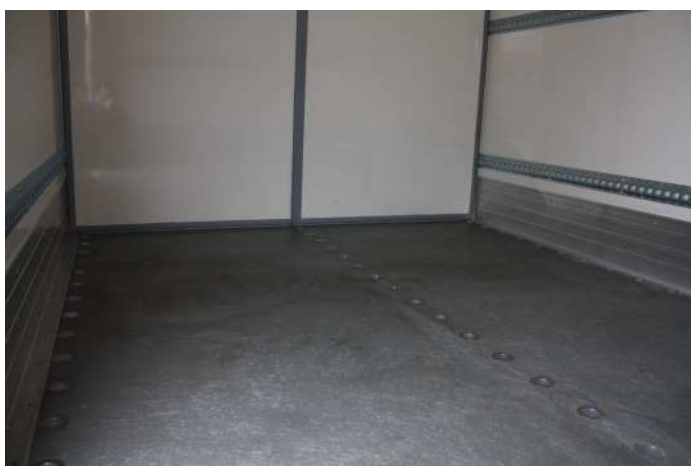
Kanały rozprowadzające ciepłe powietrze w podłodze- na środku i przy ścianach bocznych – stosowane w nadwoziach do transportu kwiatów i rozsąd roślin.
