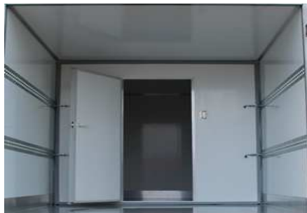
System zabezpieczania ładunku za pomocą przesuwanej ściany grodziowej
